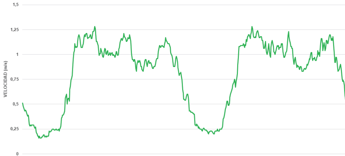
Gráfica 2: Velocidades (m/s) obtenidas en la conducción para el rango de caudales simulado.
